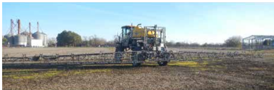
Pulverizadora Pla con tecnología de aplicaciones selectivas instalada
